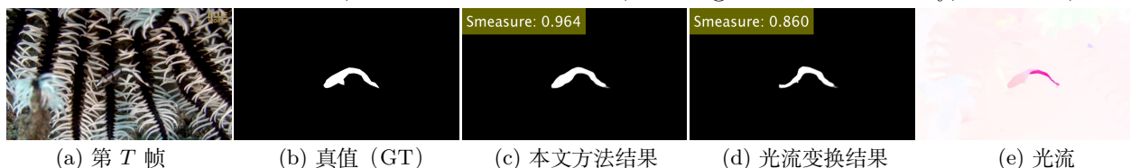
Figure 1: 隐式的 (本文方法) 与显式的 (光流方法) 运动处理结果的对比。(c) 本文方法得到的第 T 帧的伪装物体检测的结果 (由第 T-1 帧和第 T 帧计算得到)。(d) 光流法得到的第 T 帧的伪装物体检测的结果 (由第 T-1 帧使用预先计算的光流进行变换得到, 其中, 光流如 (e) 所示)。可以看出, 基于显式的方法 (即光流法) 进行伪装物体检测, 会导致准确性显著下降 (降低 10.79%), 本文将对其进行进一步讨论。
